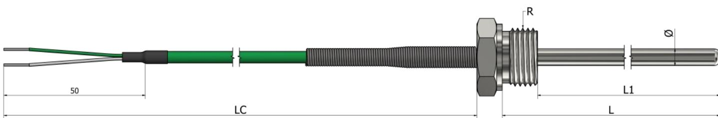
\*Materijal tubice Nerđajući čelik 316L
