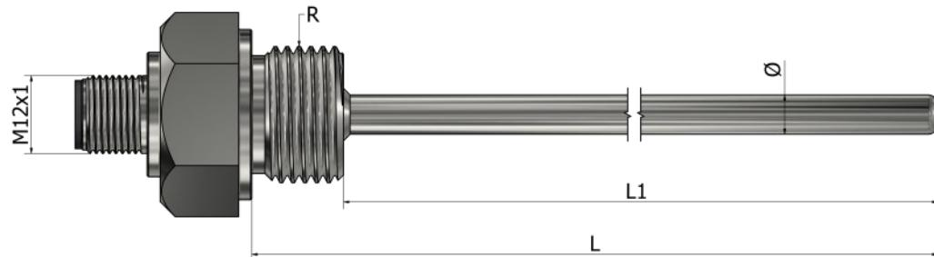
\*Materijal tubice Nerđajući čelik 316L
