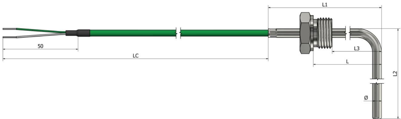
\*Materijal tubice **Nerđajući čelik 316L**
