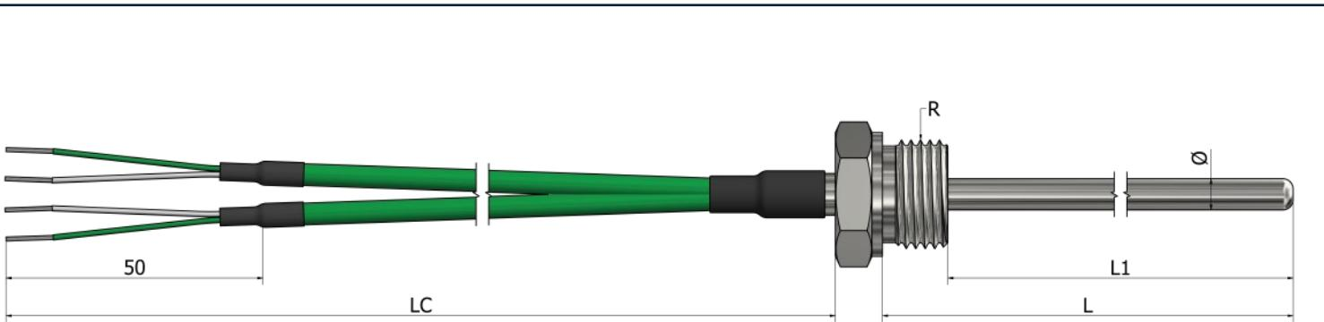
\*Materijal tubice Nerđajući čelik 316L
