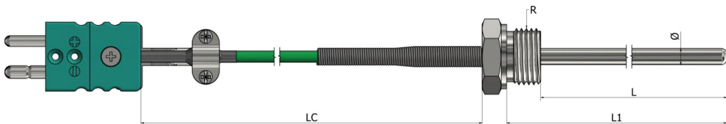
\*Materijal tubice Nerđajući čelik 316L
