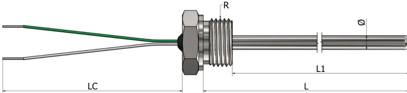
\*Materijal tubice Nerđajući čelik 316L
