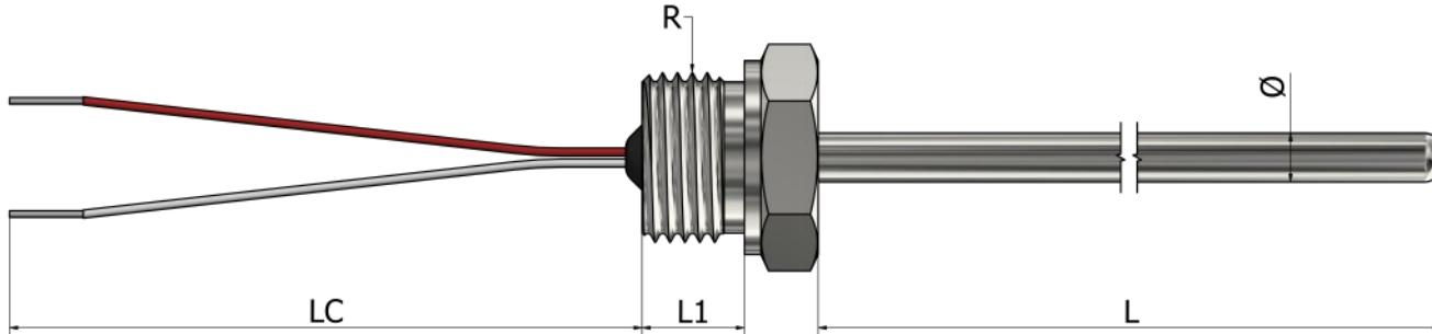
\*Materijal tubice Nerđajući čelik 316L
