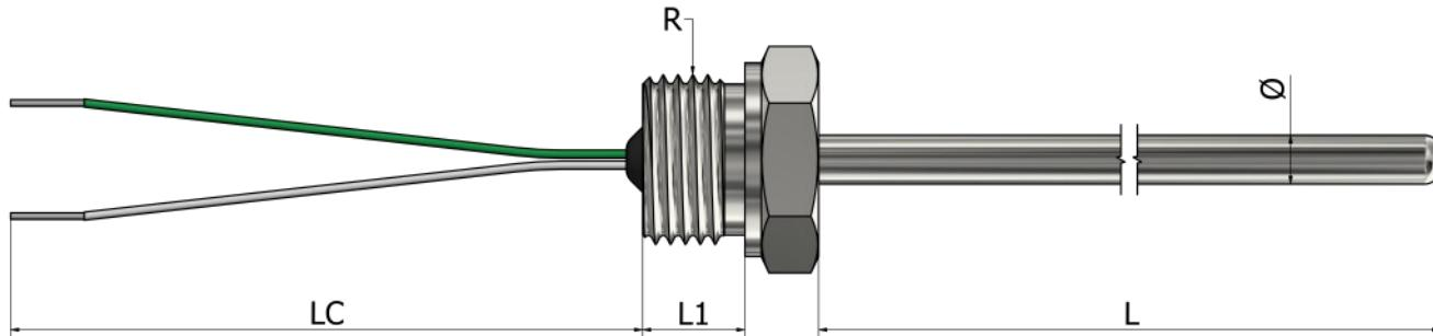
\*Materijal tubice Nerđajući čelik 316L
