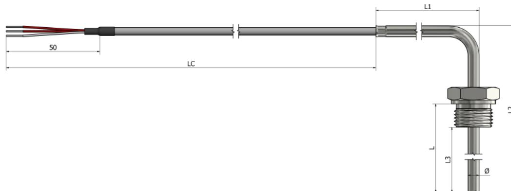
\*Materijal tubice Nerđajući čelik 316L
