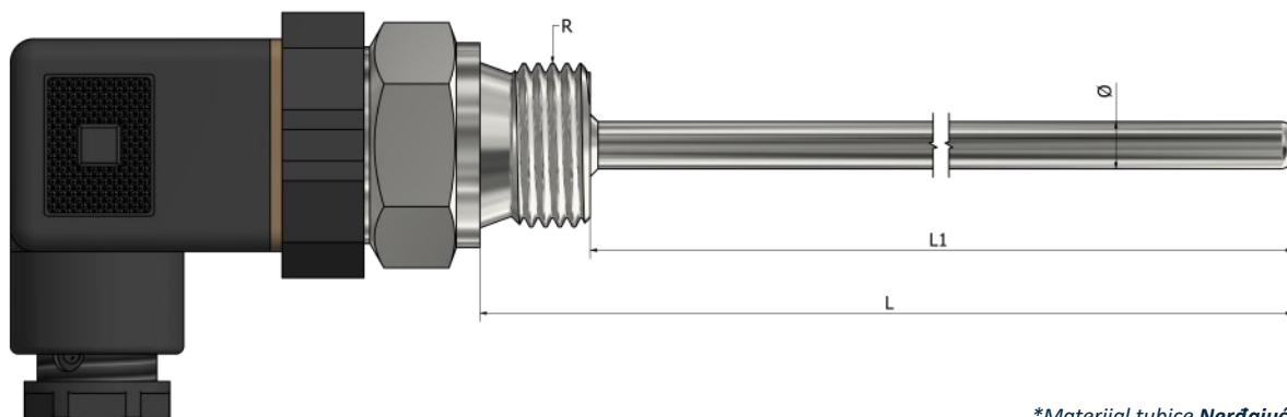
\*Materijal tubice Nerđajući čelik 316L
