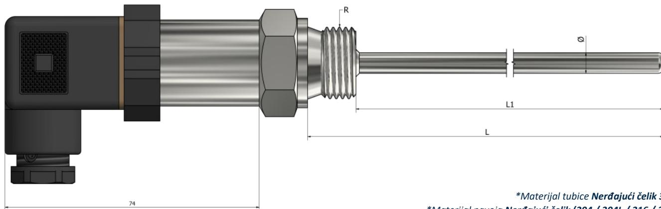
\*Materijal tubice Nerđajući čelik 316L
