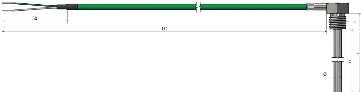
\*Materijal tubice Nerđajući čelik 316L
