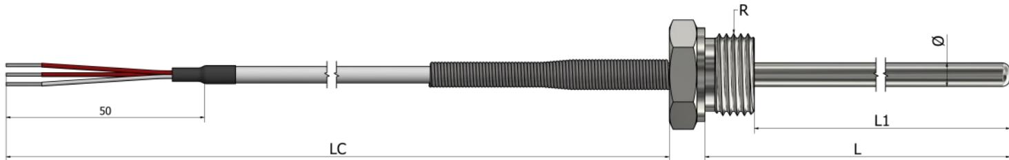
\*Materijal tubice Nerđajući čelik 316L
