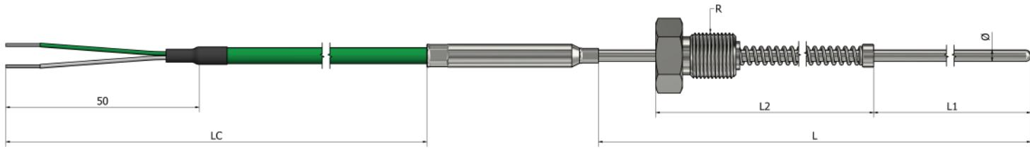
\*Materijal tubice **Nerđajući čelik 316L**
