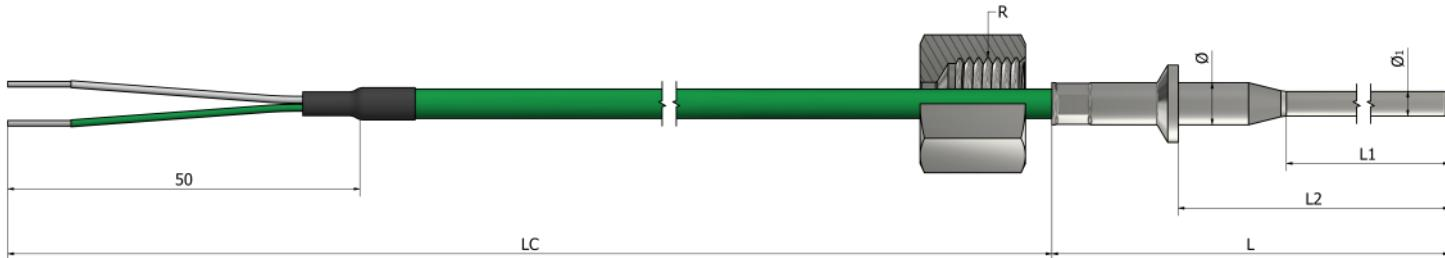
\*Materijal tubice **Nerđajući čelik 316L**
