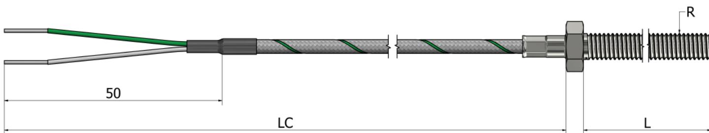
\*Materijal vijka **Nerđajući čelik (304 / 304L / 316 / 316L)**
