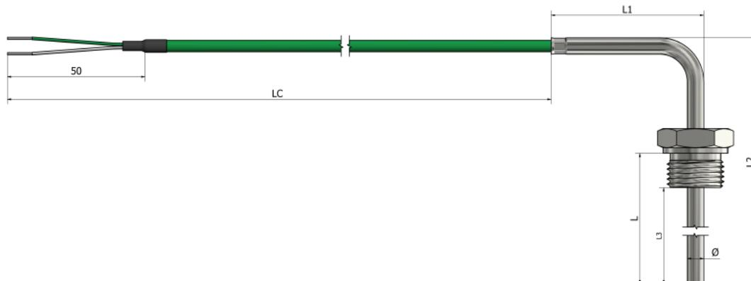
\*Materijal tubice Nerđajući čelik 316L
