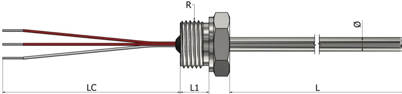
\*Materijal tubice Nerđajući čelik 316L
