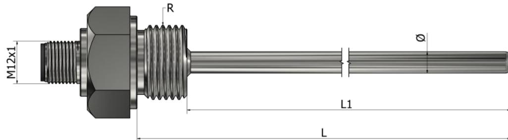
\*Materijal tubice Nerđajući čelik 316L
