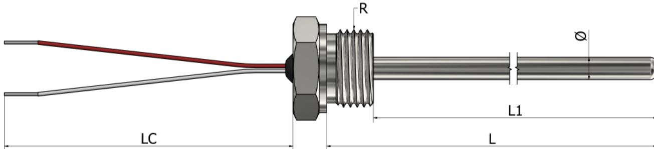
\*Materijal tubice Nerđajući čelik 316L
