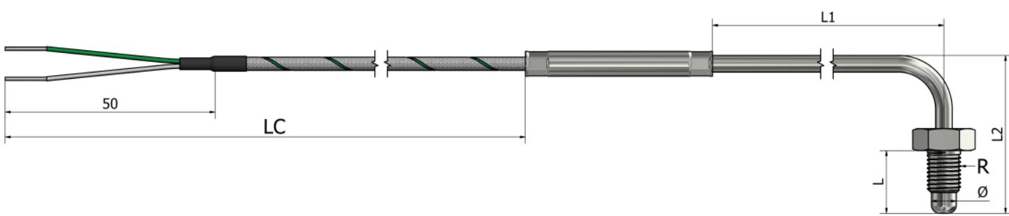
\*Materijal tubice Nerđajući čelik 316L
