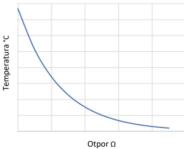
NTC termistori su nelinearni otpornici koji menjaju svoje otpornosti sa temperaturom. Jednostavno rečeno, kako temperatura raste, otpornost termistora opada.
