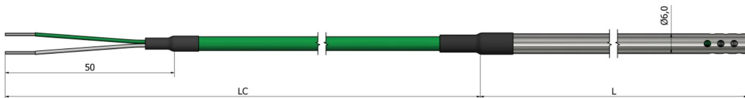
\*Materijal tubice Nerđajući čelik 316L
