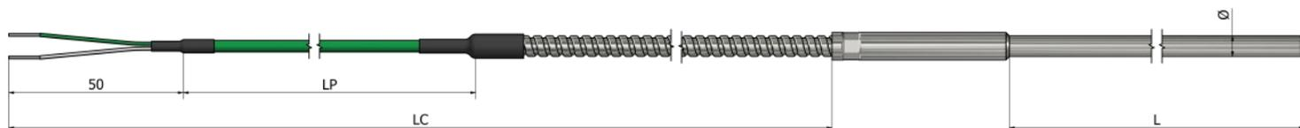
\*Metalni bužir Nerđajući čelik 316L
