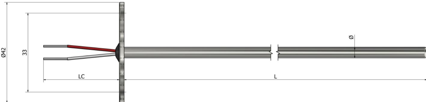
\*Materijal cevi Nerđajući čelik 316L
