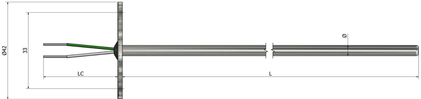
\*Materijal cevi Nerđajući čelik 316L
