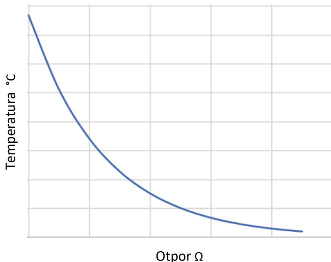
NTC termistori su nelinearni otpornici koji menjaju svoje otpornosti sa temperaturom. Jednostavno rečeno, kako temperatura raste, otpornost termistora opada.
