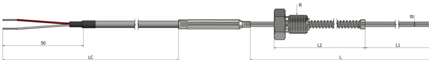
\*Materijal tubice **Nerđajući čelik 316L** \*Materijal navoja **Nerđajući čelik (304 / 304L / 316 / 316L)**
