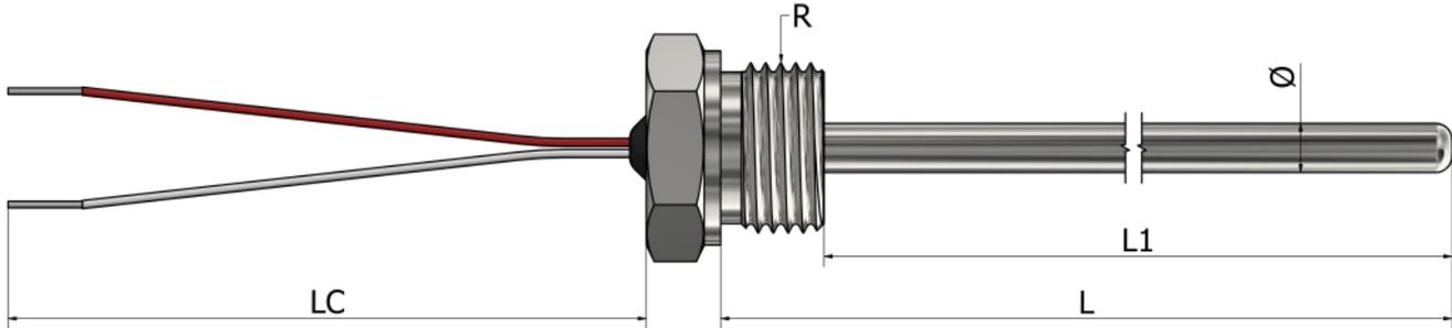
\*Materijal tubice Nerđajući čelik 316L
