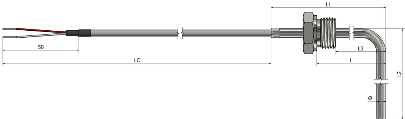
\*Materijal tubice **Nerđajući čelik 316L**
