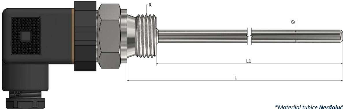
\*Materijal tubice **Nerđajući čelik 316L**
