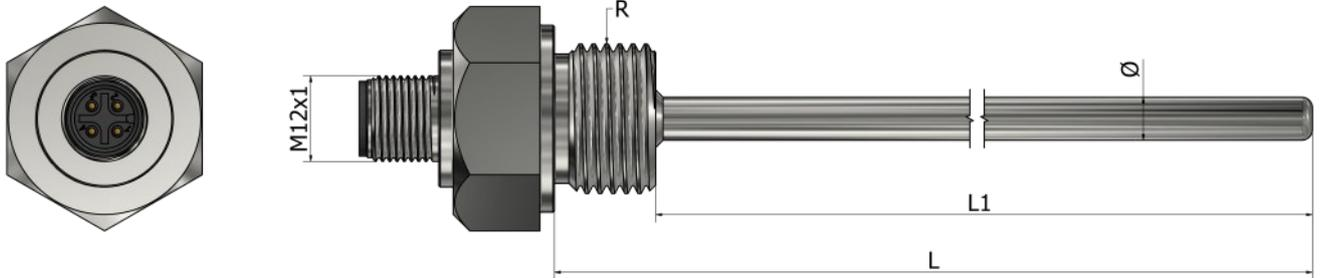
\*Materijal tubice **Nerđajući čelik 316L**
