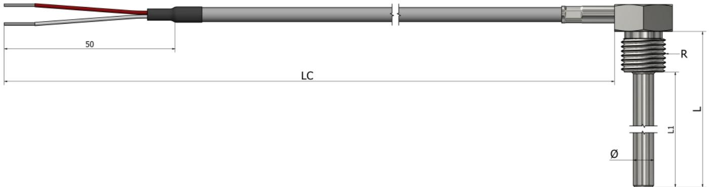
\*Materijal tubice **Nerđajući čelik 316L**
