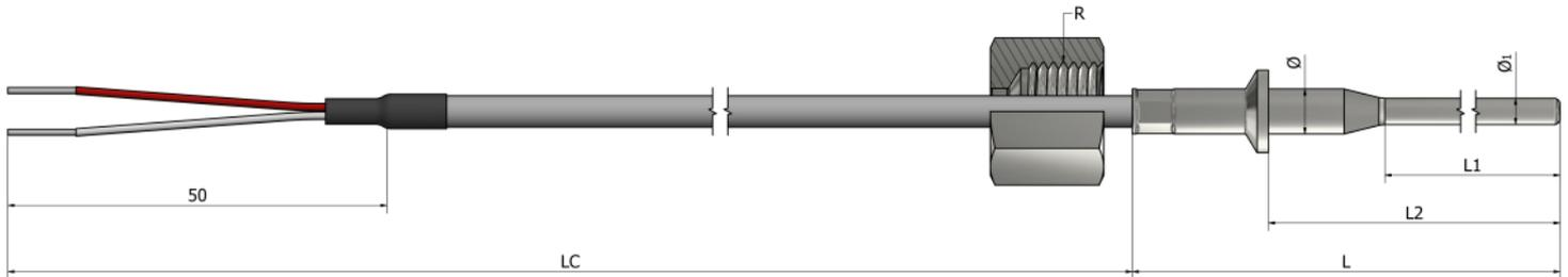
\*Materijal tubice **Nerđajući čelik 316L** \*Materijal navoja **Nerđajući čelik (304 / 304L / 316 / 316L)**
