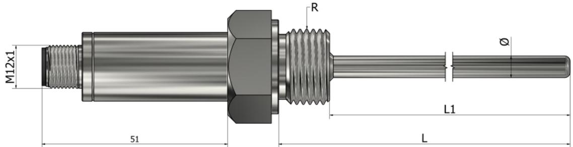
\*Materijal tubice **Nerđajući čelik 316L**
