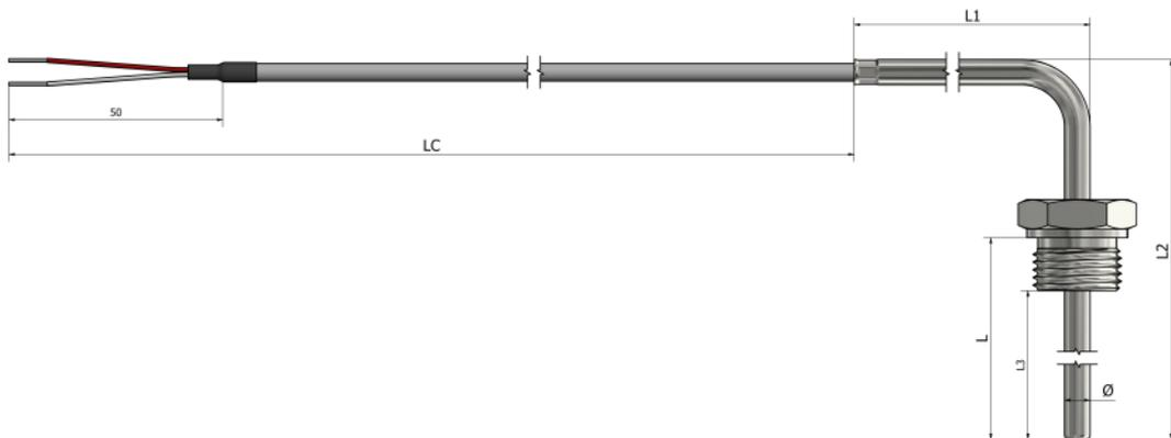
\*Materijal tubice **Nerđajući čelik 316L**
