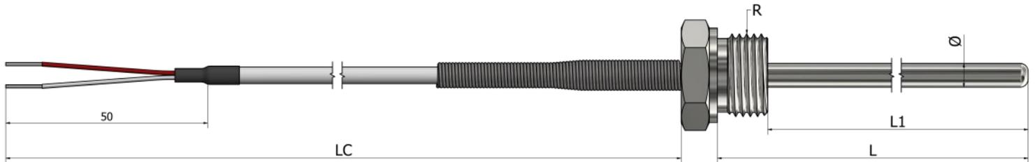
\*Materijal tubice Nerđajući čelik 316L
