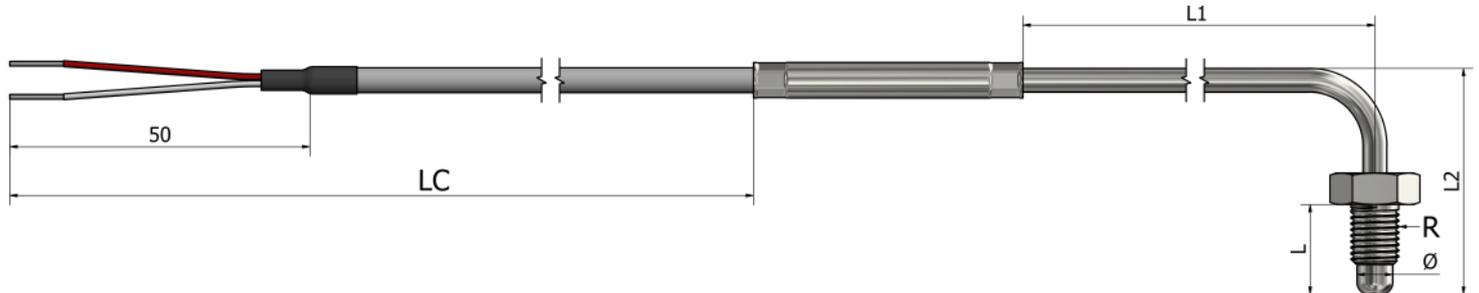
\*Materijal tubice **Nerđajući čelik 316L**
