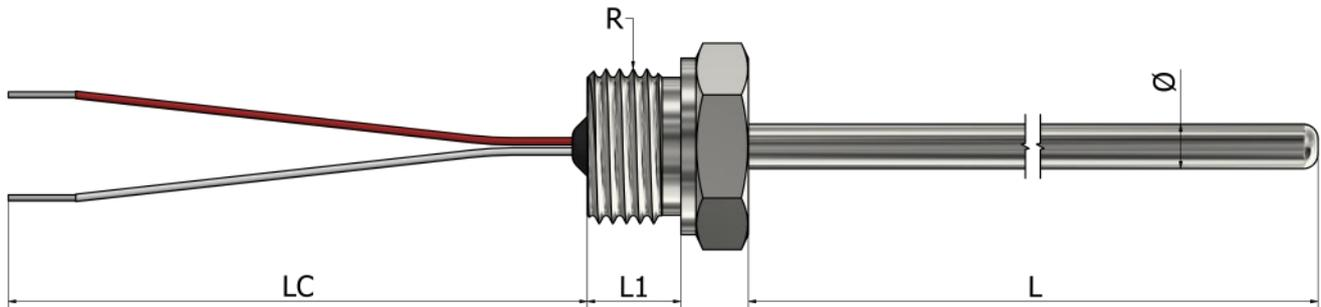
\*Materijal tubice Nerđajući čelik 316L
