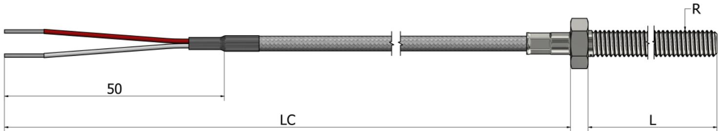
\*Materijal vijka Nerđajući čelik (304 / 304L / 316 / 316L)
