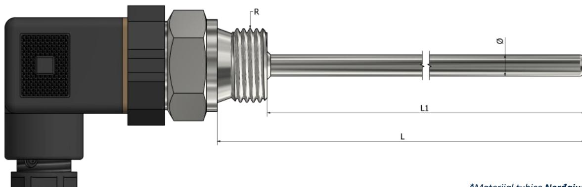
\*Materijal tubice Nerđajući čelik 316L
