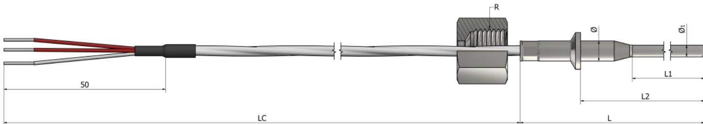
\*Materijal tubice **Nerđajući čelik 316L**
