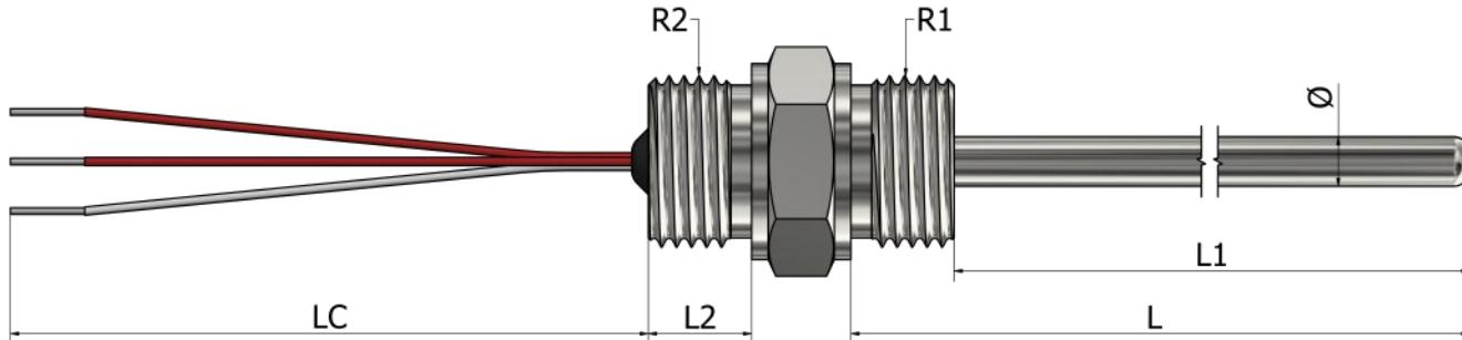
\*Materijal tubice Nerđajući čelik 316L
