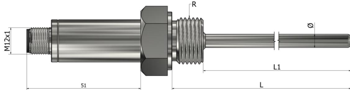
\*Materijal tubice Nerđajući čelik 316L
