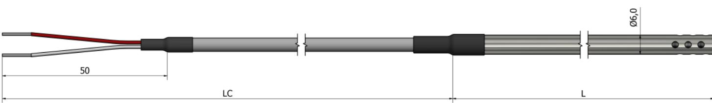
\*Materijal tubice Nerđajući čelik 316L
