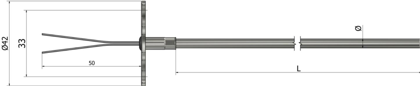
\*Materijal disk ploče Nerđajući čelik 304L
