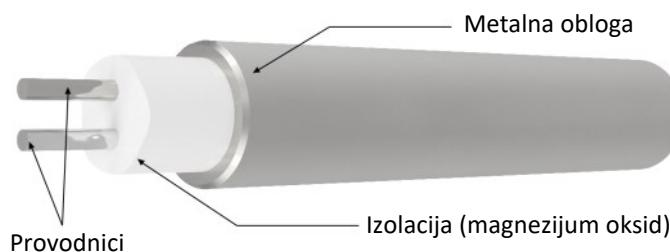
Ova konstrukcija donosi mnoge prednosti za senzore temperature. Mineralno izolovane sonde često se nazivaju „Manteli“. Od nemačke reči Mäntel što znači mantil/plašta.
