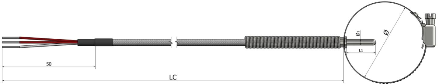
\*Matériau du collier **Inox 316L** \*Matériau du tube **Inox 316L**
