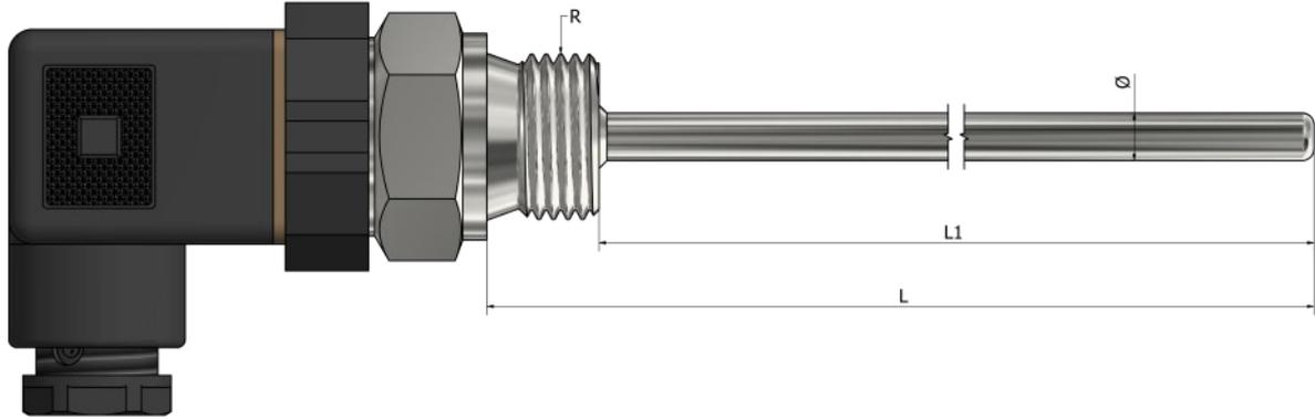
\*Matériau du tube **Inox 316L** \*Matériau du raccord **Inox (304 / 304L / 316 / 316L)**
