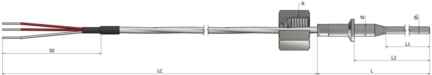
\*Matériau du tube **Inox 316L** \*Matériau du raccord **Inox (304 / 304L / 316 / 316L)**
