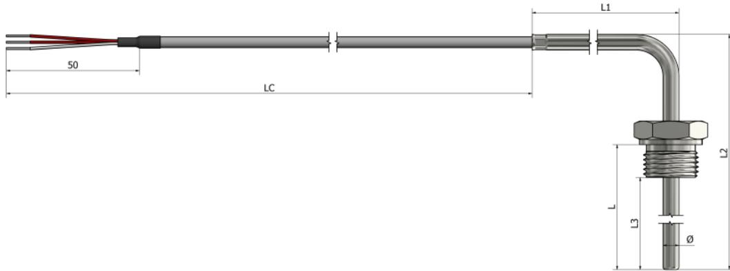
\*Matériau du tube **Inox 316L** \*Matériau du raccord **Inox (304 / 304L / 316 / 316L)**
