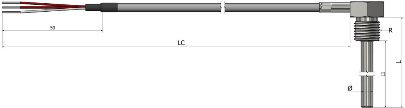
\*Matériau du tube **Inox 316L** \*Matériau du raccord (**304 / 304L / 316 / 316L**)
