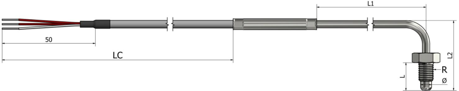
\*Matériau du tube **Inox 316L** \*Matériau de la buse et du raccord **Inox (304 / 304L / 316 / 316L)**
