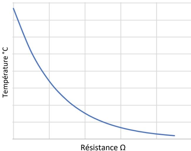
Les thermistances NTC sont des résistances non linéaires dont les caractéristiques de résistance varient avec la température. En termes simples, à mesure que la température augmente, la résistance de la thermistance diminue.
